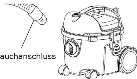
Abb. 7: Montage des Saugschlauchs
