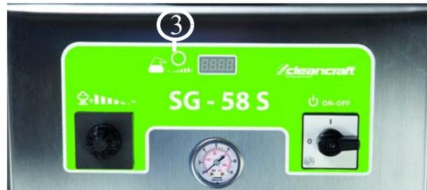
Abb. 5: Funktionstaste Reinigungsmittel
