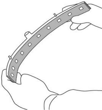
Abb. 30: Saugleiste entfernen
