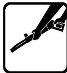
Das Sprührohr ist während des Betriebs einer Schubkraft ausgesetzt. Halten Sie es daher immer fest mit beiden Händen.
