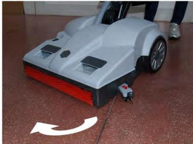
11. In den Kurven dreht sich die Sauglippe in Gegenrichtung der Maschine um das Wasser perfekt aufzusaugen
