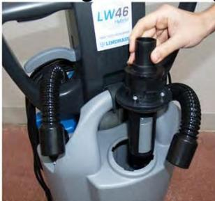
1. Die Schläuche entfernen, den Filter/Schwimmer Deckel im Gegenuhrzeigersinn drehen und vom Tank entfernen, den Haken heben und den Tank entfernen
