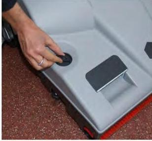
6. Den Druck je nach Bodenart und Arbeitsgeschwindigkeit anpassen
