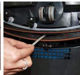
8. Im Falle einer Verstopfung mit einem Plastikröhrchen kontrollieren, dass die Saugöffnung frei ist
