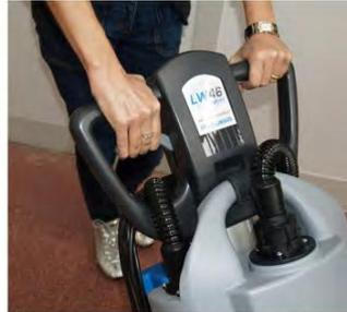
7. Den Hebel ziehen und den Handgriff in die gewünschte Arbeitsposition herunterlassen
