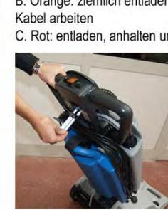
12. Nach der Benützung immer den Hebel heben um die Rolle und die Sauglippe vom Boden aufzuheben
