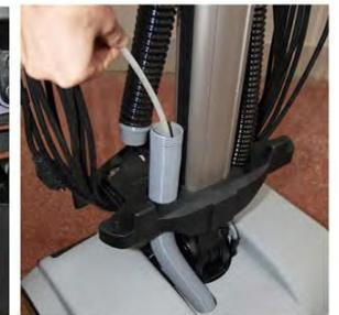
9. Falls die Verstopfung weiter oben liegt, den Schlauchanschluss kontrollieren. Auch die obere Schlauchkurve kontrollieren
