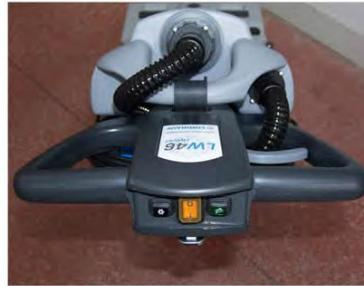
8. Den Hauptschalter (orange), Saugschalter (links) und den Pumpenschalter (rechts) einschalten
