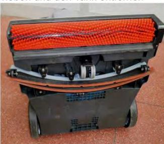
6. Nachdem beide Tanks abmontiert worden sind, die Maschine auf den Rücken flachlegen und mit einem nassen Schwämmchen die Rollenzonen, den Kehr Gummi, die Sauglippe und den Fuß reinigen
