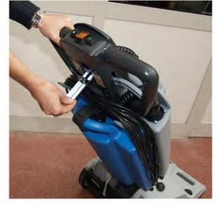
5. Den Hebel für die Arbeitsposition herunterlassen
