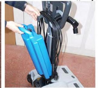
5. Den Frischwassertank abmontieren und leeren um zu verhindern, dass eventuelle Wasseraustritte den Boden beschädigen
