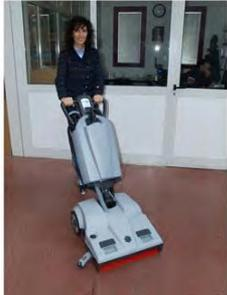
10. Beide Hebel drücken und die Maschine in die gewünschte Richtung begleiten
