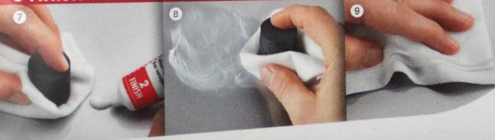
SONAX Finish 2 aus der zweiten Tube auf die vorpolierte Stelle geben (**Bild 7**). Eine neue saubere Stelle des PolierVlieses wie vorher mehrmals falten, um den PolierStempel wickeln und so lange mit mittlerem Druck reiben, bis der gewünschte Oberflächenglanz erreicht ist (**Bild 8**). Abschließend Polierrückstände mit PolierVlies abwischen (**Bild 9**). Vor Frost schützen. Darf nicht in die Hände von Kindern gelangen.
