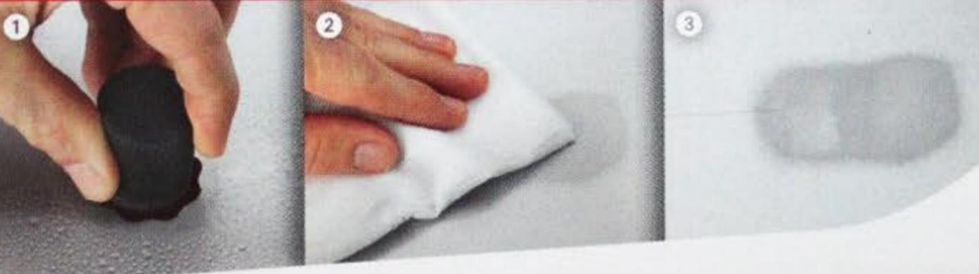
Je nach Tiefe des Kratzers kann ein Anschleifen erforderlich sein. Dazu den Lack mit Wasser anfeuchten, eine der beiliegenden Schleifblüten unter den PolierStempel kleben und mit minimalem Druck kreisförmig über dem Kratzer behutsam schleifen (**Bild 1**). Nicht bis zur Grundierung durchschleifen und nicht verkanten! Anschließend Schleifrückstände mit einem beiliegenden PolierVlies abwischen (**Bild 2**). Es bleibt eine matte Stelle zurück (**Bild 3**).
