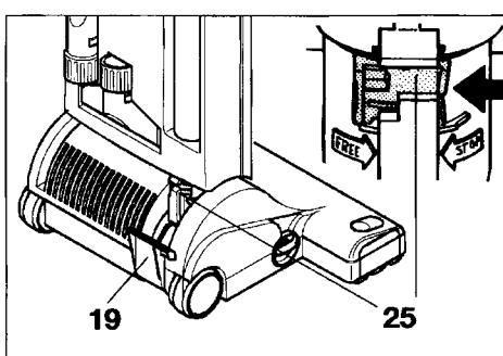
Das Rastpedal (19) drücken, um das Gerät zu schwenken. Mit dem orangefarbenen Schieber (25) ist eine weitere Rastposition zur Überwindung von Hindernissen und Teppichkanten einstellbar. Das Pedal dann erneut auslösen, um flach auf den Boden zu schwenken.
