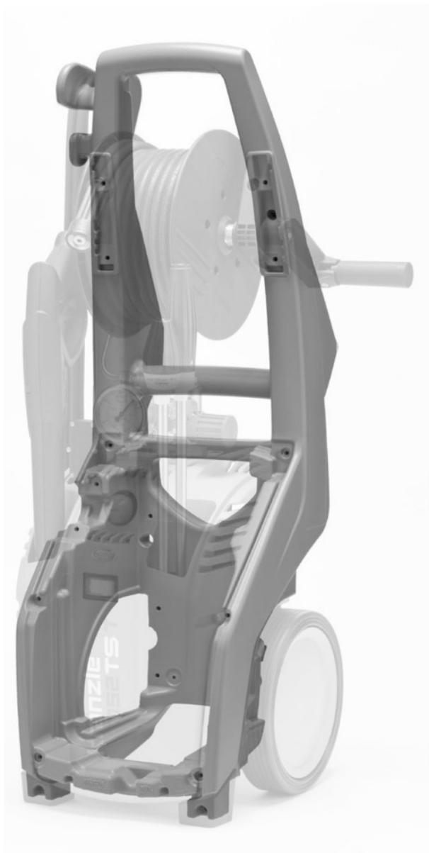
Zentrales Element des neu konzipierten Hochdruckreinigers K 1152 TS T ist der selbsttragende Rahmen, der in der Produktion im Werk 2 in Illertissen/Bayern nach dem Rotationsinterverfahren als durchgängiges Rotationsformteil hergestellt wird. Dieser äußerst feste und verwindungssteife Rahmen sorgt für eine Maximierung der Stabilität des Hochdruckreinigers. Motor und Pumpe liegen gut geschützt im Rahmen und sind damit vor Einwirkungen von außen weitgehend abgeschirmt.
