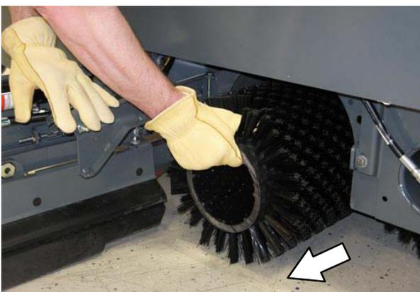
6. Bringen Sie die neuen oder gewendeten Bürsten an, indem Sie sie an den Enden abwärts drücken, während Sie sie auf die Antriebsmotor-Naben schieben.
