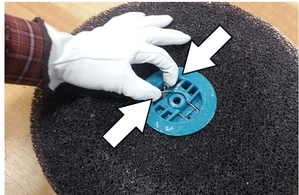
3. Wenden oder ersetzen Sie die Polierscheibe und zentrieren Sie die Polierscheibe auf dem Polierscheibenantrieb. Bringen Sie anschließend die Zentrierscheibe zur Sicherung der Polierscheibe am Antrieb an.
