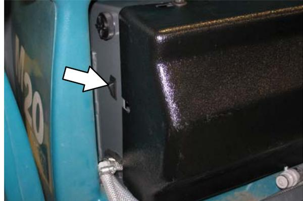
7. Drücken Sie den ec-H<sub>2</sub>O-Modul-Spülschalter, um das System abzuschalten.
