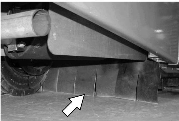
Die Schürzen müssen sich zwischen 0 und 6 mm oberhalb des Bodens befinden, wenn der Schrubbkopf abgesenkt ist.
