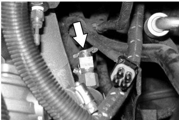
Anordnung des Ablasshahns bei benzinbetriebenen Maschinen. Entfernen Sie die Verkleidung aus dem Fahrerraum, um an den Ablasshahn zu gelangen.
