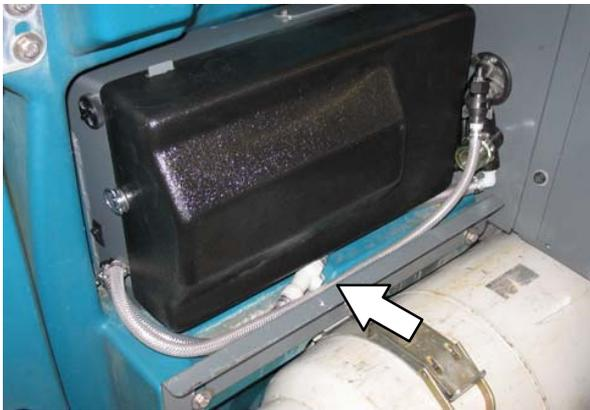
*HINWEIS: Die Einlass- und Auslassschläuche müssen zwischen der ec-H2O-Einheit und der Halterung angebracht sein, damit sie nicht eingeklemmt oder beschädigt werden, wenn die Abdeckung des Fahrersitzes geschlossen wird.*
