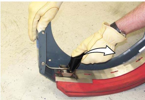
4. Entfernen Sie die Wischblätter, den Einlegling und die Halterung von der Wischgumi-Stoßstange.
