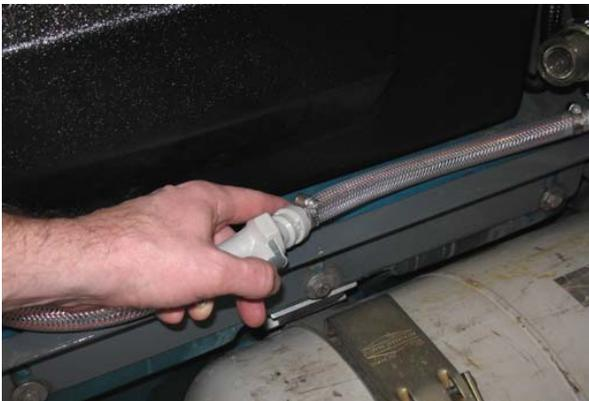
4. Lösen Sie den Auslassschlauch des ec-H2O-Systems vom Schlauch zum Schrubbkopf und schließen Sie den Auslassspülschlauch (schwarzer Anschluss) an den Auslassschlauch des ec-H2O Systems an.
