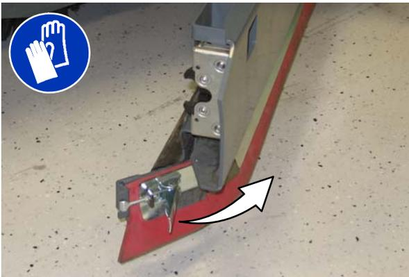
4. Entfernen Sie die Bandhalterung von der Seiten-Wischgummi-Einheit.
