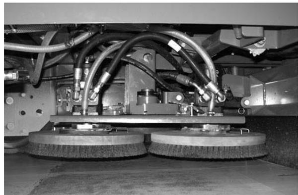
4. Drehen Sie die Bürsten, bis die Federhebel sichtbar sind.
