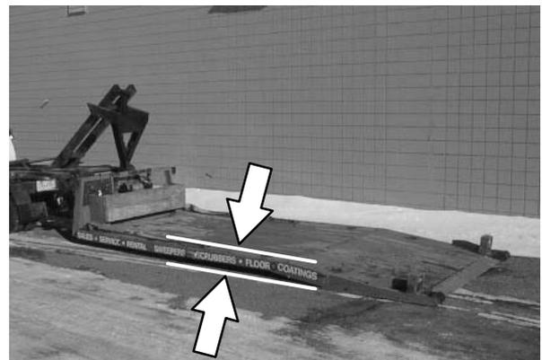
**VORSICHT: Benutzen Sie eine Winde, wenn Sie die Maschine auf einen Lastkraftwagen oder Anhänger laden. Fahren Sie die Maschine nicht auf einen Lastkraftwagen oder Anhänger, es sei denn, die Ladefläche ist horizontal UND 380 mm oder weniger über dem Boden.**
