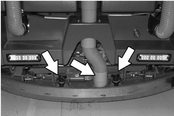
3. Entfernen Sie die Befestigungsknöpfe von der hinteren Wischgummi-Einheit.
