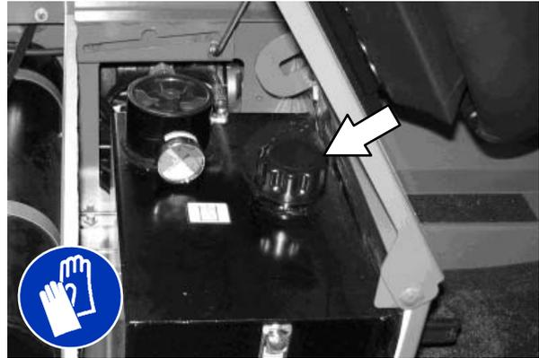
Wechseln Sie den Hydraulikfilter alle 1200 Betriebsstunden oder wenn sich die Hydraulikbehälteranzeige im gelben/roten Bereich befindet, wenn die im Behälter befindliche Hydraulikflüssigkeit etwa 32° C ist.
