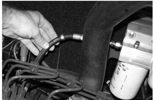
Kraftstoffleitungen aus Gummi unterliegen einer natürlichen Alterung, auch wenn die Maschine wenig oder gar nicht benutzt wird. Wechseln Sie die Kraftstoffleitungen und die Schellen alle zwei Jahre.
