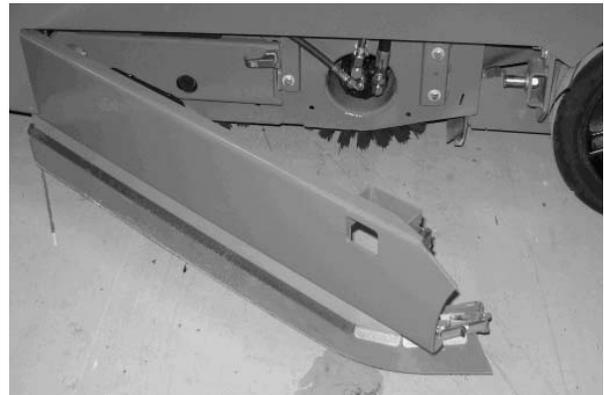
3. Öffnen Sie die inneren Bürstenklappen.
