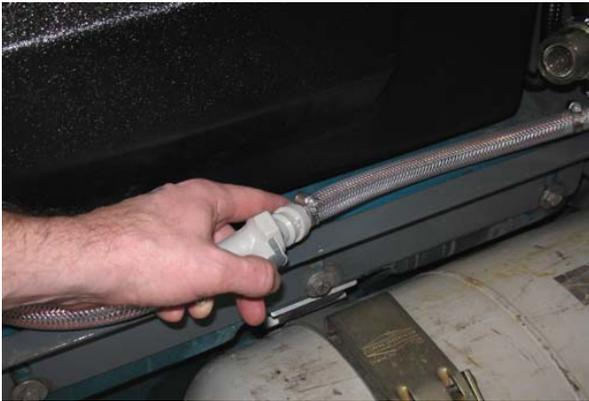
4. Ziehen Sie den Ablassschlauch zwischen der ec-H<sub>2</sub>O-Einheit und dem Fahrerraum heraus, entfernen Sie den Verschluss des Schlauchs und führen Sie das Ende des Schlauchs in einen leeren Behälter. Legen Sie den Verschluss zur Seite.
