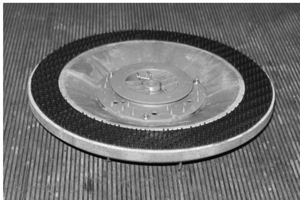
**Flornoppenantrieb** – Der standardmäßige Polierscheibenantrieb hat kurze Borsten, oder so genannte "Flornoppen" auf der Rückseite, die das Pad an der richtigen Stelle halten. Dieser Antrieb funktioniert mit allen Tennant-Pads, außer mit der schwarzen Hochleistungsscheibe.
