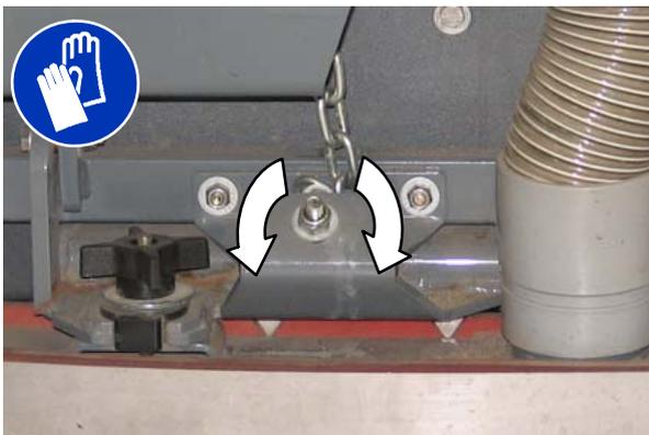
4. Drehen Sie die Wischgummi-Stellmutter nach links, um die Durchbiegung an den Enden des Wischgummis zu verringern.
