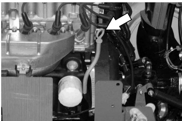
Füllen Sie Motoröl ein, bis der Ölstand sich zwischen den Anzeigen auf dem Messstab befindet. Füllen Sie NICHT mehr Öl ein als bis zur oberen Markierung. Die Motoröl-Füllmenge beträgt mit Ölfilter 3,5 l.
