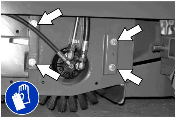
2. Bewegen Sie das Bürstenantriebsgehäuse nach oben, um die Breite des Abdrucks an dieser Seite des Schrubbkopfes zu verringern, oder nach unten, um die Breite des Bürstenabdruck an dieser Seite des Schrubbkopfes zu vergrößern.
