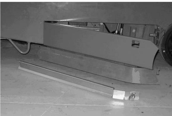
5. Entfernen Sie das Seiten-Wischblatt. Wenn die äußere Kante des Wischblattes nicht verschlissen ist, tauschen Sie das Wischblatt gegen das Wischblatt von der anderen Seite der Maschine aus. Entsorgen Sie das Wischblatt, wenn beide Kanten verschlissen sind.
