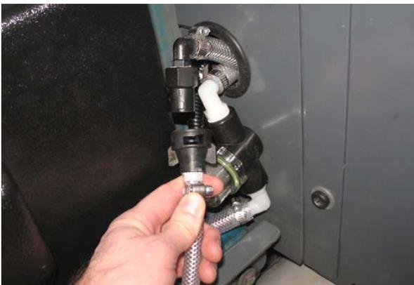
5. Führen Sie den Einlassschlauch des ec-H2O-Systems in einen Behälter mit 19 Liter weißem Essig oder Reissessig. Führen Sie den Auslassschlauch in einen leeren Behälter.
