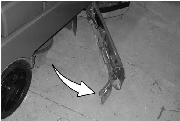
3. Inspizieren Sie die Anschlagstoßstangen des Scheibenschrubbkopfes. Stellen Sie die Stoßstangen ein, wenn der Schrubbkopf nicht parallel zum Fußboden ist. Abgenutzte oder beschädigte Stoßstangen müssen ersetzt werden.
