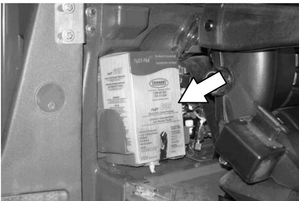
Wenn die Maschine im optionalen ES-Betrieb (Verlängerter Schrubbbetrieb) betrieben wird, wird das im Schmutzwassertank gesammelte Schmutzwasser gefiltert und durch das ES-System zur Wiederverwendung in den Frischwassertank rezirkuliert. Das Reinigungsmittel wird dann in das rückgeleitete Frischwasser injiziert, wodurch die Reinigungsleistung des Frischwassers aufgefrischt wird.
