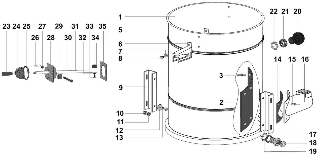
Ersatzteilzeichnung 4 - Behälter (Untere Baugruppe) / Spare part drawing 4 - Tank (down)
