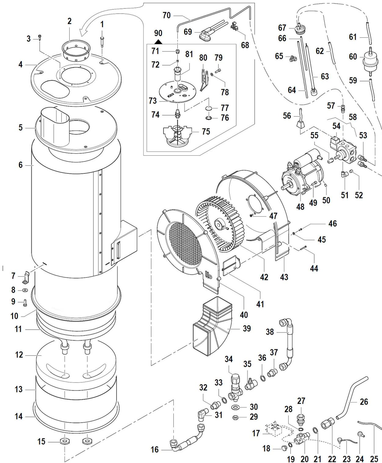
Abb. /Fig8: Ersatzteilzeichnung 10 / Spare parts drawing 10
