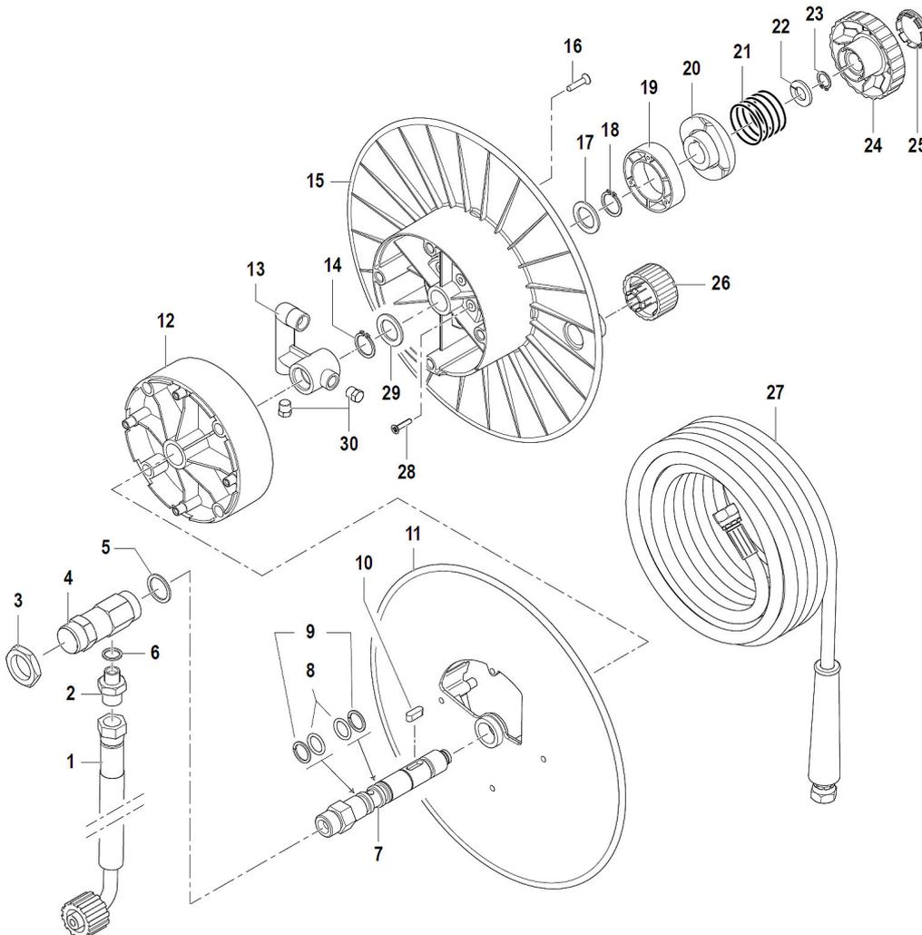
Abb. /Fig. 6: Ersatzteilzeichnungen 7 & 8 / Spare parts drawings 7 & 8
