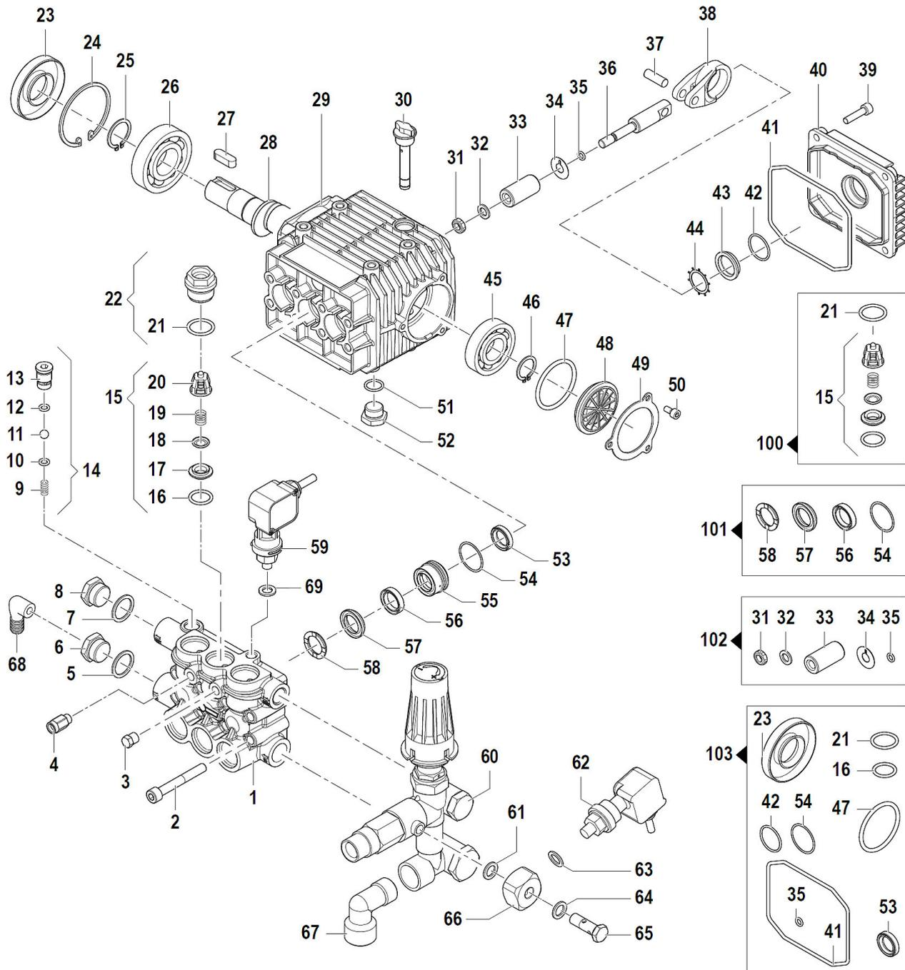
Abb. / Fig. 4: Ersatzteilzeichnung 5 / Spare parts drawing 5
