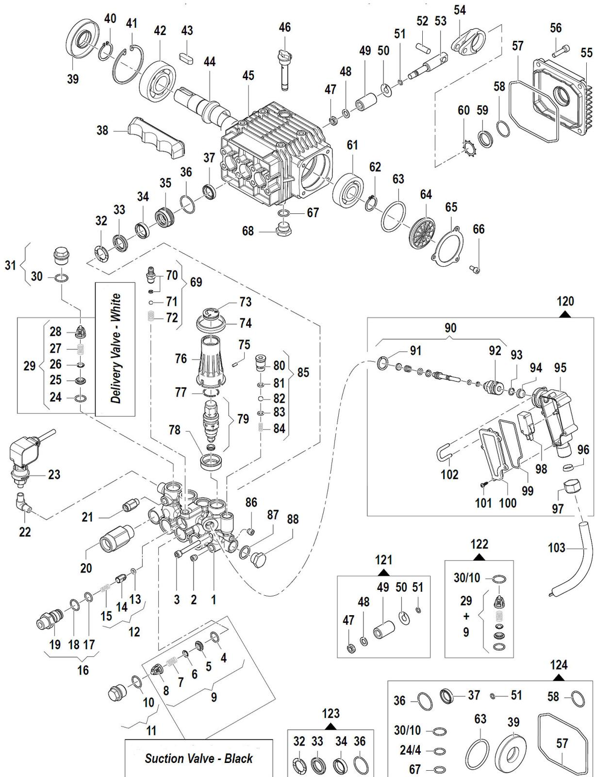
Abb. / Fig. 3: Ersatzteilzeichnung 4 / Spare parts drawing 4
