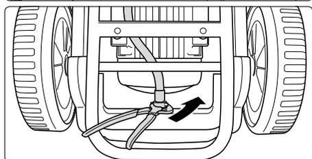
**1.** Verbindungsschlauch zwischen Hochdruckpumpe und Wasserkasten am Wasserkasten abschrauben.
