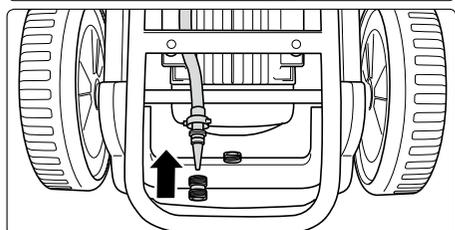
**2.** Schlauchverbinder 2x3/4" (46.004) mit dem Verbindungsschlauch verschrauben.
