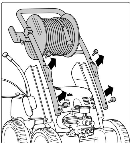
Lösen Sie die 4 Befestigungsschrauben und nehmen Sie den Fahrbügel mit der Schlauchtrommel ab.
