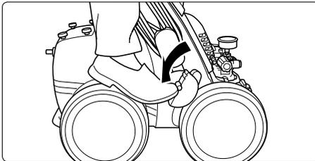
**3. Feststellbremse lösen.**
