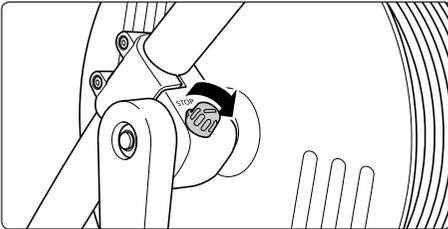
**8.** Fixierung der Schlauchtrommel lösen.
