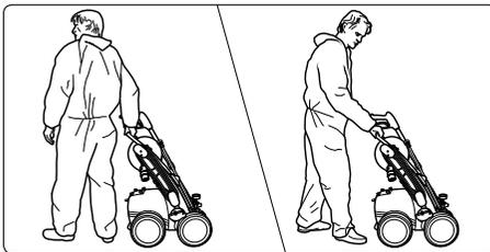
**4. Gerät zum Einsatzort bewegen.** Die Kränzle-quadros sind fahrbare Maschinen mit robusten geländegängigen Fahrwerken.
