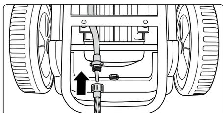
**3.** Saugschlauch mit dem Schlauchverbinder (46.004) verschrauben. Der Schlauchinnenquerschnitt muß mindestens 3/4" = 16 mm aufweisen.
