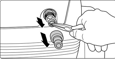
**1. Vor jeder Inbetriebnahme Wassereingangssieb auf Sauberkeit überprüfen.** Schlauchaufnahme per Hand abschrauben. Mit einer spitzen Zange das serienmäßige Wassereingangssieb herausnehmen und bei Verschmutzung säubern.
