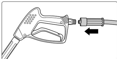
**10.** Hochdruckschlauch an die Pistole aufstecken.
