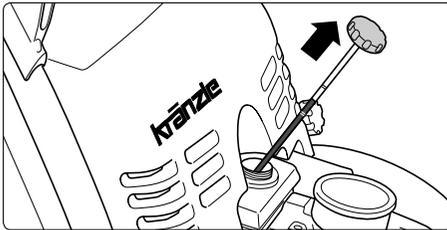
**2. Vor jeder Inbetriebnahme Ölstand überprüfen.** Der Ölstand am Ölmeßstab muß zwischen den beiden Markierungen liegen.
