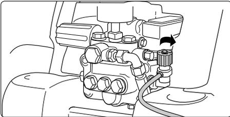
1. Zusatzmittelsieb in Behälter mit Reinigungsmittel stecken.
