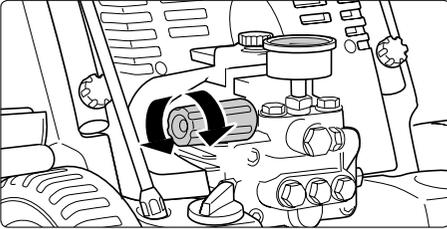
**14.** Arbeitsdruck stufenlos mit dem Handrad regeln. Der maximal verfügbare Druck ist werkseitig fest eingestellt
