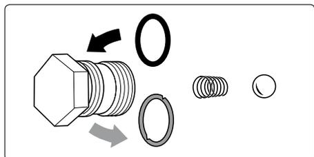
Dichtungsringe bei Defekt austauschen.
