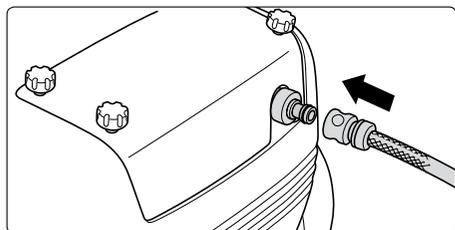
**12.** Wasserschlauch an den Wasserkasten anschließen. Das Gerät kann wahlweise an eine Druckwasserleitung mit kaltem oder bis zu 60 °C warmen Wasser angeschlossen werden.
