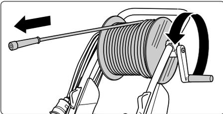
**9.** Hochdruckschlauch gerade und schlingenfrei von der Schlauchtrommel abrollen.
