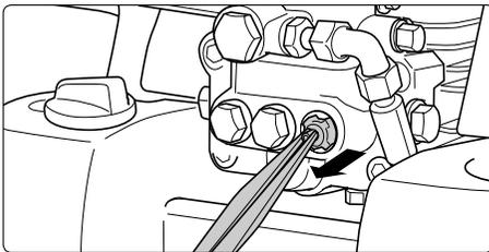
Entnehmen Sie die Ventilkörper (mit grüner oder roter Plastikummantelung) samt O-Ring mit einer spitzen Zange.
