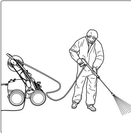
**16.** Gerät bei geöffneter Spritzpistole einschalten. Maschine entlüften: Pistole mehrmals öffnen und schließen und mit dem Waschvorgang beginnen.
