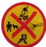
Hochdruckstrahlen können bei unsachgemäßem Gebrauch gefährlich sein. Der Strahl darf nicht auf Personen, Tiere, aktive elektrische Ausrüstung oder auf die Maschine selbst gerichtet werden.
