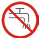
Das Gerät darf nicht unmittelbar an das öffentliche Trinkwassernetz angeschlossen werden.
