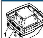
Regulaminie czyścić czujniki poziomu wody (1) i sprawdzać pod kątem widocznych uszkodzeń.
