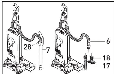
Zur Benutzung des Teleskoprohres (7) und des Teleskopschlauchs (6) das Gerät in die aufrechte Position bringen. Dann das Teleskoprohr nach oben herausziehen und den Schlauch spannen bis er einrastet. Zum Zurückstecken das Teleskoprohr in das Gelenk einführen und es dann mit dem Griff auf den Nocken am Filtergehäuse stecken.
