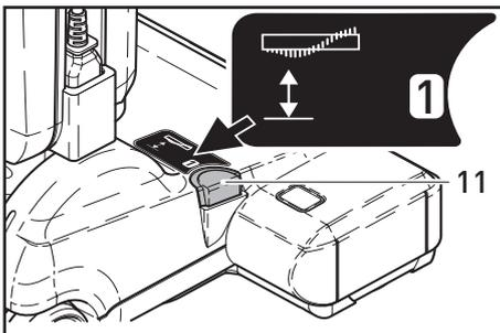
Durch Druck der Taste (11) kann die Bürste von Stufe 1 (niedrigste Stufe) bis 4 (höchste Stufe) und wieder zurück eingestellt werden. Zur Einstellung der Bürste empfehlen wir Ihnen zunächst auf Stufe 2 zu beginnen. Je nach Schiebekraft können Sie die Bürste auf Stufe 3 bzw. 4 nachregeln. Für eine hohe Energieeffizienz und tiefgründige Reinigung Ihres Teppichbodens gemäß EU Verordnung 665/2013 empfehlen wir die Nutzung Ihres Bürststaubsaugers auf Stufe 1.
