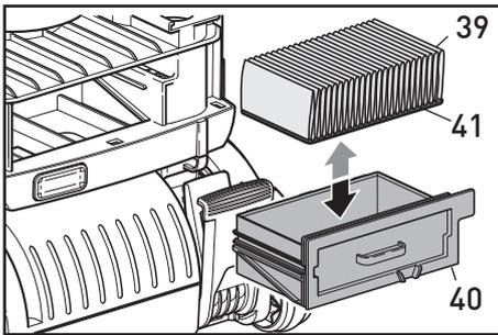
Das Filtergehäuse kann nur geschlossen werden, wenn alle Filter korrekt eingelegt sind. Die Filter nicht waschen.
