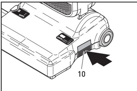
Die Gelenkkraste (25) arretiert den SEBO Bürststaubsauger in senkrechter Ruhelage. Zum Lösen der Gelenkkraste das Rastpedal (19) treten und das Gerät nach hinten kippen. Der Ein-/Aus-Schalter (10) befindet sich ergonomisch unten an der Seite des Gerätefußes. Zum Ein- und Ausschalten den Schalter mit dem Fuß betätigen.
