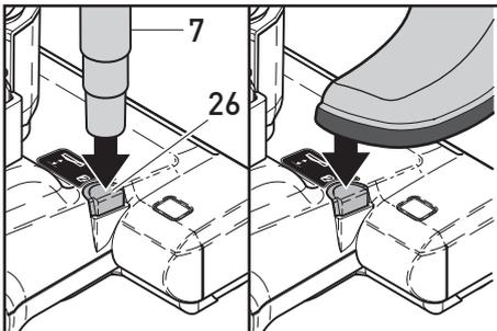
Die Bürstenhöhe Ihres SEBO Bürststaubsaugers kann entweder per Fuß oder mit Hilfe des Teleskoprohrs eingestellt werden. Hierfür das Gerät in die aufrechte Position stellen und das Teleskoprohr nach oben herausziehen. Die Öffnung des Teleskoprohrs (7) passt in die Einkerbung (26) der Bürsteneinstellung (11).
