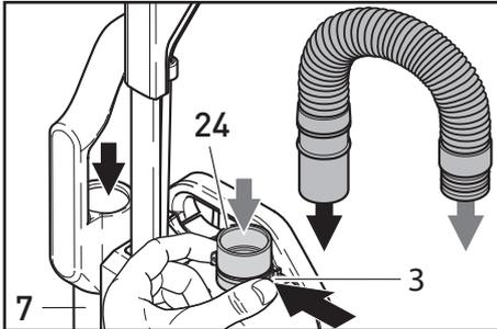
Die passende Schlauchseite in das Teleskoprohr(7) einführen. Zum Anschließen des Schlauches an das Filtergehäuse, das Ende mit der schwarzen Buchse in die Verbindungshülse(24) einführen und ganz einschieben. Durch Zusammendrücken der Griffflächen am Sicherungsring(3) kann der Schlauch wieder gelöst werden. **Wenn das Gerät nicht läuft, überprüfen ob die Teile richtig zusammen gesteckt sind.**
