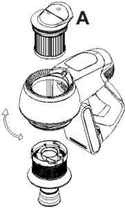
Ziehen Sie den EPA Filter an der Kappe **(A)** nach oben heraus. Drehen Sie den EPA Filter nach links, um ihn von der Abdeckung zu lösen. Ersetzen Sie ihn durch einen neuen Filter und setzen Sie ihn in umgekehrter Reihenfolge wieder ein.
