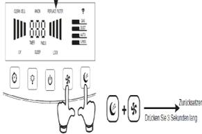
Wenn REPLACE FILTER auf dem Display angezeigt wird, wird empfohlen den H.E.P.A Filter des Gerätes zu wechseln. Sobald der H.E.P.A Filter ersetzt wurde, gehen Sie bitte wie folgt vor:
