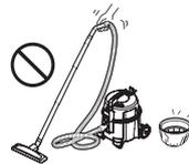
Stellen Sie sicher, dass der Filter nach der Entsorgung des Staubes eingesetzt wird. Wenn der Staubsauger ohne eingesetzten Filter verwendet wird, wird der Staub direkt in die mechanischen Teile gesaugt und kann den Motor beschädigen.
