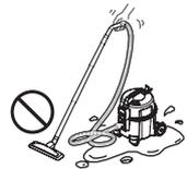
Verwenden Sie den Staubsauger nicht zur Aufnahme feuchten Schmutzes und verwenden Sie ihn nicht an nassen oder feuchten Orten, da Feuchtigkeit den Motor und andere mechanische Teile beschädigt.
