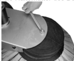
Kippen Sie die Kehrmaschine nach hinten (Griff auf den Boden für einen stabilen Halt und sicheren Zugang) und entfernen Sie das Stützrad.
