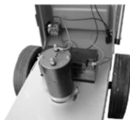
Lösen Sie die Keilriemenspannschrauben auf beiden Seiten des Elektromotors, so dass sich die Seite mit dem Langloch verschieben lässt. Diese spannt bzw. entspannt den Keilriemen.
