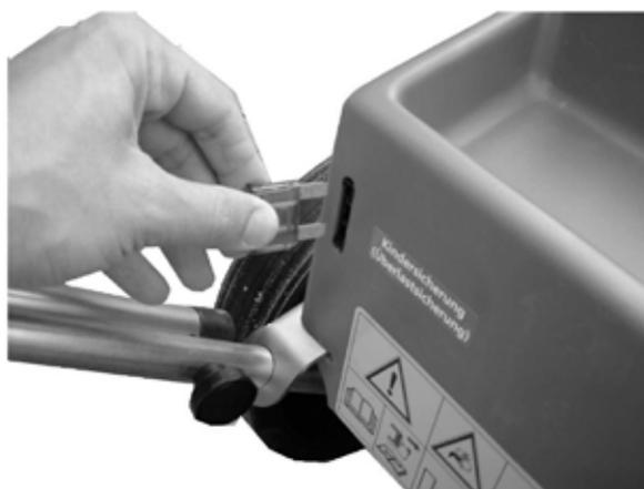
Gleichzeitig dient die Sicherung als Absperrvorrichtung, da durch das Abziehen der Sicherung die Kehrmaschine vor unberechtigter Benutzung geschützt wird.
