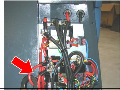
4. ripetere la procedura per il motore della spazzola anteriore che si trova sul lato sinistro del basamento mettendo la pinza amperometrica sul cavo **n20A** .
