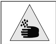
Deutet auf Gefahr von Gasausdünstungen und Auslaufen von korrodierenden Flüssigkeiten hin
