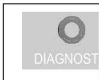
Symbol, das die Kontrollleuchte für eine Betriebsstörung des Antriebs kennzeichnet
