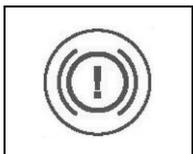
Symbol Feststellbremse aktiviert oder Störung Flüssigkeitsstand im Bremssystem
