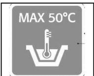
Symbol, das die Höchsttemperatur des Wassers für die Befüllung des Reinigungstanks angibt
