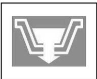
Symbol, das die Position des Abflussschlauchs des Reinigungslösungstanks angibt
