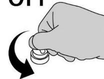
5. Nehmen Sie den Schlauch (4) aus dem entsprechenden Sitz, schrauben Sie den Ablassverschluss ab und entleeren Sie den Schmutzwassertank.
