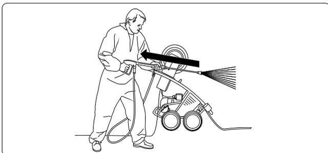
**Achten Sie darauf, daß beim Reinigen mit unter Hochdruck stehendem Wasser an der Lanze ein deutlich spürbarer Rückstoß entsteht. (siehe techn. Daten S. 4)**
