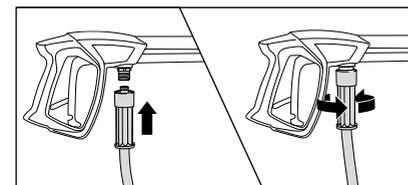
5. Hochdruckschlauch an die Sicherheits-Abschalt-pistole aufstecken, fest und druckdicht verschrauben.
