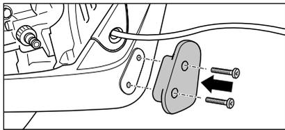
1. Die untere Kabelaufwicklung für das Netzanschlusskabel an der dafür vorgesehenen Stelle, mit den mitgelieferten Schrauben am Rahmen verschrauben.
