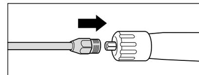
6. Lanze auf die Sicherheits-Abschalt-pistole aufstecken.
