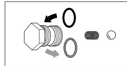
Sind die Dichtungsringe defekt, sofort O-Ringe austauschen.
