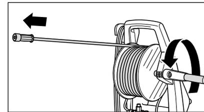
4. Bei Hochdruckreinigern mit Schlauchtrommel, muss diese ganz abgewickelt werden. Bei Hochdruckreinigern ohne Schlauchtrommel muss der im Lieferumfang enthaltene Hochdruckschlauch an den Pumpenausgang fest und druckdicht aufgeschraubt werden. Hochdruckschlauch gerade und schlingenfrei ausrollen.
