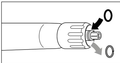
Schalten Sie den Hochdruckreiniger aus. Betätigen Sie zum Druckabbau kurz die Sicherheits-Abschaltpistole. Schrauben Sie Hochdruckschlauch, Sicherheits-Abschaltpistole und Lanze ab und kontrollieren Sie die Dichtungsringe. Sind die Dichtungsringe defekt, sofort O-Ringe austauschen.
