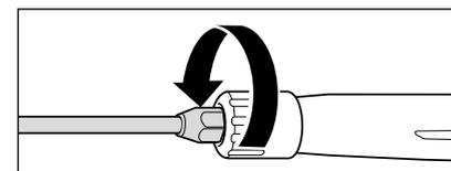
7. Lanze mit der Sicherheits-Abschalt-pistole fest und druckdicht verschrauben.
