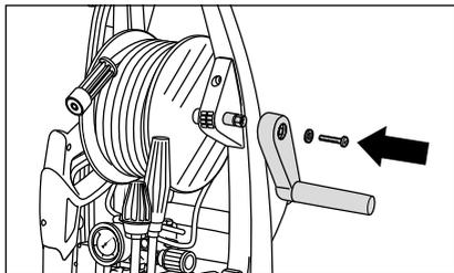
2. Bei den Hochdruckreinigern mit Schlauchtrommel muss die beiliegende Handkurbel vor der ersten Inbetriebnahme angebracht werden. Stellen Sie den Hochdruckreiniger auf. Handkurbel auf den Sechskant aufstecken und mit der beiliegenden Scheibe und Schraube befestigen.
