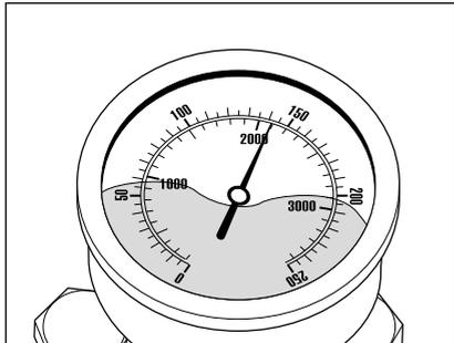
Nach dem Schließen der Sicherheits-Abschaltpistole muss sich der Hochdruckreiniger abschalten. Das Edelstahlmanometer muss jetzt „0“ bar anzeigen. Wenn die Abschaltung nicht erfolgt und das Edelstahlmanometer weiterhin vollen Druck anzeigt, kann Leckage an der Hochdruckpumpe, am Druckschalter, am Hochdruckschlauch, oder an der Sicherheits-Abschaltpistole die Ursache sein.
