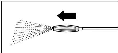
2. Zum Erreichen des Niederdrucks Vario-Düse nach vorn schieben, damit der Injektor das Zusatzmittel ansaugen kann.
