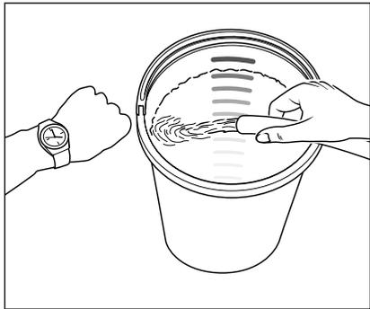
Wassermangel kommt häufiger vor als man denkt. Je leistungsstärker ein Hochdruckreiniger ist, umso größer ist die Gefahr, dass zu wenig Wasser zur Verfügung steht. Bei Wassermangel entsteht in der Hochdruckpumpe Kavitation (Wasser-Gas-Gemisch), was in der Regel nicht oder zu spät bemerkt wird.
