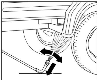
Bei Verwendung der Unterbodenlanze muss diese unbedingt aufgelegt werden! Es ist darauf zu achten, dass bei gebogenen bzw. abgewinkelten Spritzlanzen ein nicht unerhebliches Drehmoment im Rückstoß entsteht! (Die Unterbodenlanze ist ein Zubehörteil und optional erhältlich.)
