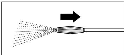
3. Beim Zurückschieben der Vario-Düse wird die Chemiezufuhr automatisch geschlossen, der Hochdruckreiniger schaltet auf Hochdruck um. Zusatzmittel einwirken lassen und dann mit Hochdruck absprühen.
