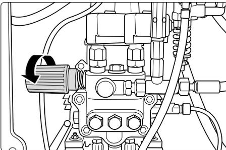
Mit dem Druckregelventil am Pumpenkopf wird der Arbeitsdruck sowie der Wasserdurchfluß und in Abhängigkeit davon auch die Wassertemperatur gesteuert. Drehung nach rechts erhöht den Druck, Drehung nach links vermindert den Druck.
