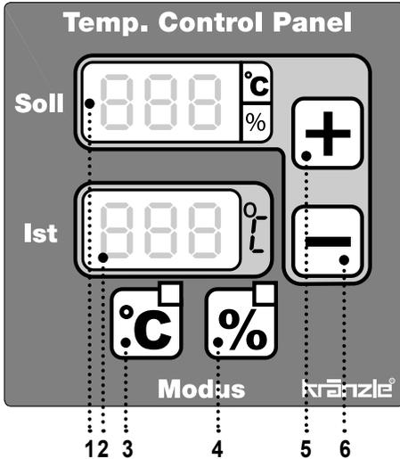
Der Thermostat regelt die Spritzwassertemperatur. Nach dem Einschalten des Gerätes erscheint in beiden Anzeigen für ca. 1 Sekunde "888" als Test für die Funktionsfähigkeit der Anzeigen.
