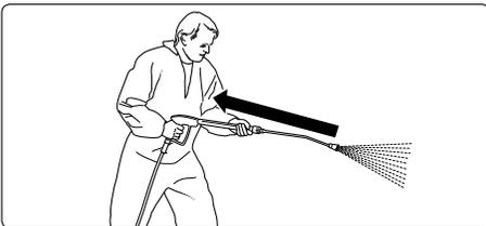
Achten Sie darauf, daß beim Reinigen mit dem Hochdruckstrahl an der Lanze ein deutlich spürbarer Rückstoß entsteht. Bei abgewinkelten Lanzen kommt ein deutliches Drehmoment hinzu.
