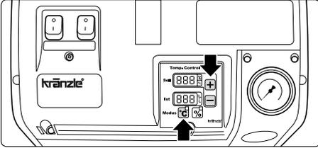
2. a) Temperaturmodus: Gewünschte Temperatur am Thermostat einstellen. (Mindesttemperatur 40 °C)
