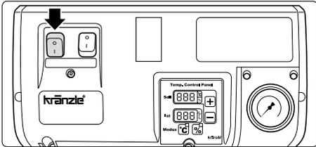
3. Geräteschalter bei geöffneter Pistole einschalten. Gerät entlüften: Pistole mehrmals öffnen und schließen.
