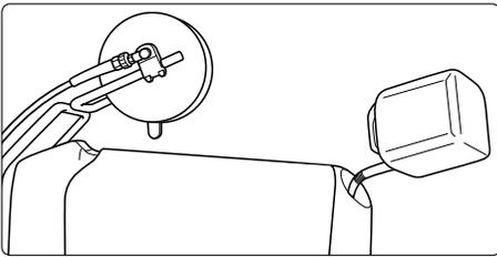
1. Reinigungsmittel in den Reinigungsmitteltank einfüllen.
