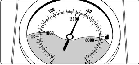
**Nach dem Schließen der Pistole zeigt das Manometer weiterhin vollen Druck an. Das Gerät schaltet sich ständig ein und aus.**
