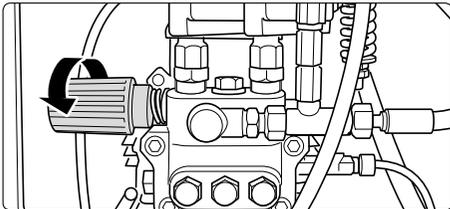
4. Mit dem Druckregelventil am Pumpenkopf wird der Arbeitsdruck reguliert: Drehung nach links verringert den Arbeitsdruck; Drehung nach rechts erhöht den Arbeitsdruck.
