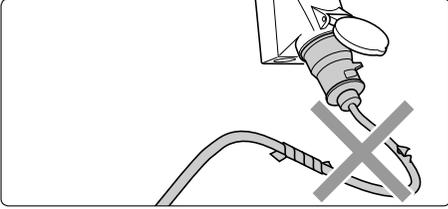
**Elektrische Kabel nur in einwandfreiem Zustand verwenden!
