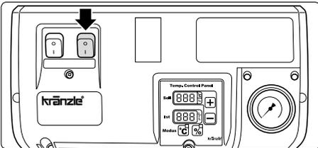
4. Heizung einschalten. Das Wasser wird erhitzt und konstant auf der eingestellten Temperatur gehalten.
