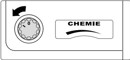
**Reinigungsmittelschalter muß geschlossen sein!** (Schalter in linker Anschlagposition)
