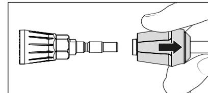
5. Die Sicherungshülse der Sicherheits-Abschalt-pistole erst zurückziehen, dann den Stecknippel der Düse in die Steckkupplung der Sicherheits-Abschalt-pistole stecken.
