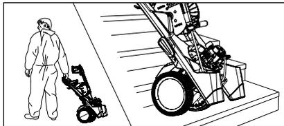
2. Den Hochdruckreiniger zum Einsatzort bewegen. Die X-Serie ist ein fahrbarer Hochdruckreiniger mit robustem geländegängigen und treppentauglichen Fahrwerk.
