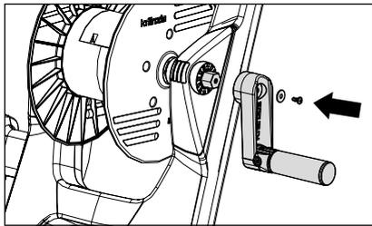
1. Bei den Hochdruckreinigern mit Schlauchtrommel muss die beiliegende Handkurbel vor der ersten Inbetriebnahme angebracht werden. Stellen Sie den Hochdruckreiniger auf. Handkurbel auf den Sechskant aufstecken und mit der beiliegenden Scheibe und Schraube befestigen.
