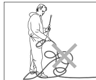
Hochdruckschlauch nicht knicken und nicht mit Schlingen ziehen! Hochdruckschlauch nicht über scharfe Kanten ziehen!
