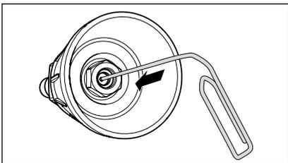
Besteht das Problem weiter, so durchstoßen Sie mit einem Draht (Büroklammer) vorsichtig die Düsenöffnung. Sollte das Reinigen mit einem Draht nicht den gewünschten Erfolg bringen, so muss die Düse ersetzt werden.
