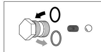
Sind die Dichtungsringe defekt, sofort O-Ringe austauschen.
