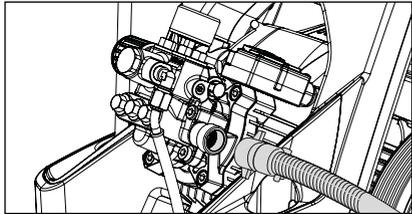
1. Saugschlauch mit Ansaugfilter (Art.-Nr.: 150383) aufmontieren.
