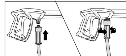
4. Hochdruckschlauch an die Sicherheits-Abschalt-pistole aufstecken, fest und druckdicht verschrauben.
