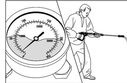
Das Manometer zeigt trotz aufgedrehter Druckregulierung nur wenig Druck. Aus der Lanze kommt ein unregelmäßiger Strahl. Der Hochdruckschlauch vibriert.
