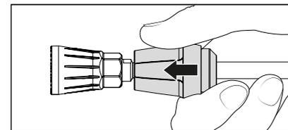
6. Nach Einstecken des Stecknippels der Düse die Sicherungshülse loslassen und auf einen sicheren Sitz der Düse achten. Stecknippel regelmäßig mit säurefreiem Fett einschmieren.
