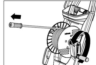
3. Bei Hochdruckreinigern mit Schlauchtrommel, muss diese ganz abgewickelt werden. Hochdruckschlauch gerade und schlingenfrei ausrollen. Der Hochdruckschlauch kann auf manchen Böden Abriebspuren hinterlassen. Alternativ finden Sie in unserem Sortiment auch Non-Marking Hochdruckschläuche.
