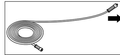
2. Hochdruckschlauch gerade und schlingenfrei ausrollen. Der Hochdruckschlauch kann auf manchen Böden Abriebspuren hinterlassen. Alternativ finden Sie in unserem Sortiment auch Non-Marking Hochdruckschläuche.
