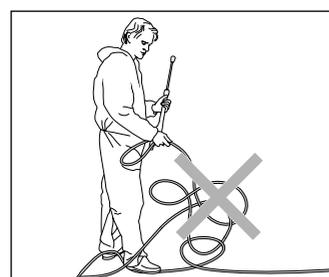
Hochdruckschlauch nicht knicken und nicht mit Schlingen ziehen! Hochdruckschlauch nicht über scharfe Kanten ziehen!
