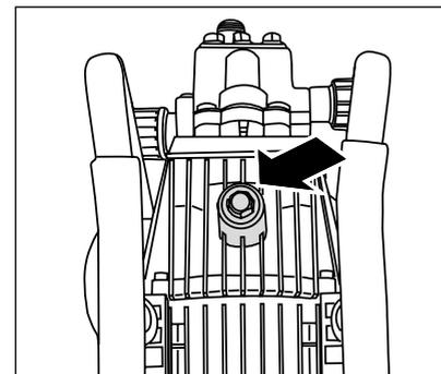
Der erste Ölwechsel muss nach ca. **50 Betriebsstunden** erfolgen. Weitere Ölwechsel sind jährlich oder nach 250 Betriebsstunden erforderlich. Nimmt das Öl einen grauen oder weißlichen Farbton an, so muss dieses auf jeden Fall gewechselt werden. Sollte es nötig sein das Öl zu wechseln, so muss die Ölablassschraube über einem Behälter geöffnet und der Hochdruckreiniger entleert werden. Das Öl muss in einem Behälter aufgefangen und anschließend vorschriftsmäßig entsorgt werden.
