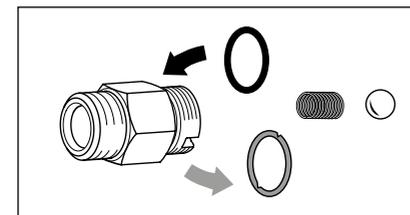
Sind die Dichtungsringe defekt, sofort O-Ringe austauschen.
