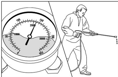
Das Edelstahlmanometer zeigt vollen Druck. Aus der Lanze kommt kein oder nur sehr wenig Wasser.
