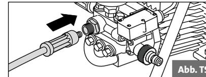
3. Den im Lieferumfang enthaltene Hochdruckschlauch an den Pumpenausgang fest und druckdicht aufschrauben.
