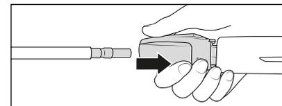
5. Die Sicherungshülse der Sicherheits-Abschaltpistole erst zurückziehen, dann die Lanze in die Steckkupplung der Sicherheits-Abschaltpistole stecken.
