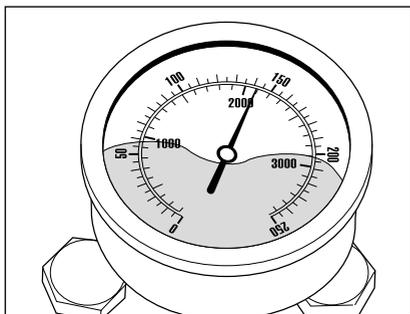
Nach dem Schließen der Sicherheits-Abschaltpistole muss das Druckregelventil-Sicherheitsventil umschalten. Das Edelstahlmanometer muss jetzt „0“ bar anzeigen. Wenn die Umschaltung nicht erfolgt und das Edelstahlmanometer weiterhin vollen Druck anzeigt, kann Leckage an der Hochdruckpumpe, am Druckschalter, am Hochdruckschlauch, oder an der Sicherheits-Abschaltpistole die Ursache sein.
