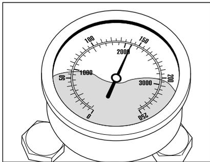
Nach dem Schließen der Sicherheits-Abschaltpistole muss sich der Hochdruckreiniger abschalten. Das Edelstahlmanometer muss jetzt „0“ bar anzeigen. Wenn die Abschaltung nicht erfolgt und das Edelstahlmanometer weiterhin vollen Druck anzeigt, kann Leckage an der Hochdruckpumpe, am Druckschalter, am Hochdruckschlauch, oder an der Sicherheits-Abschaltpistole die Ursache sein.
