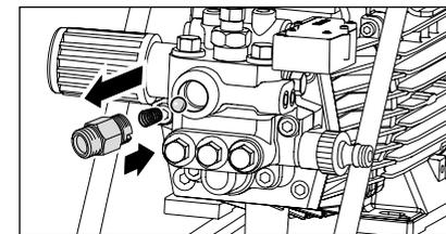
Rückschlagkörper entnehmen und den O-Ring auf Verschmutzung oder Beschädigung überprüfen. Überprüfen Sie ebenfalls den Dichtsitz im Pumpengehäuse auf Verschmutzung oder Beschädigung.
