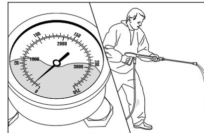
Das Edelstahlmanometer zeigt trotz aufgedrehter Druckregulierung nur wenig Druck. Aus der Lanze kommt ein unregelmäßiger Strahl. Der Hochdruckschlauch vibriert.
