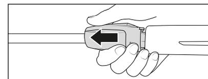
6. Nach Einstecken der Lanze die Sicherungshülse loslassen und auf einen sicheren Sitz der Lanze achten. **Stecknippel regelmäßig mit säurefreiem Fett einschmieren.**
