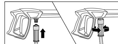
4. Stecken Sie die graue drehbare Verschraubung des Hochdruckschlauchs auf die Sicherheits-Abschaltpistole auf. Verschrauben Sie diese dann fest und druckdicht miteinander.
