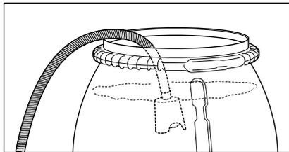
2. Mit Wasser gefüllten Ansaugschlauch in den wassergefüllten Behälter hängen und mit dem Reinigungsvorgang beginnen.
