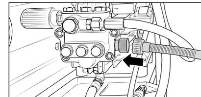
2. Saugschlauch mit Ansaugfilter (Art.-Nr.: 150383) mittels eines Doppelnippels (Art.-Nr.: 46004) mit dem Verbindungsschlauch verschrauben.
