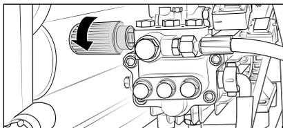
16. Arbeitsdruck stufenlos mit dem Drehgriff regeln. Der maximal verfügbare Arbeitsdruck ist werkseitig fest eingestellt.
