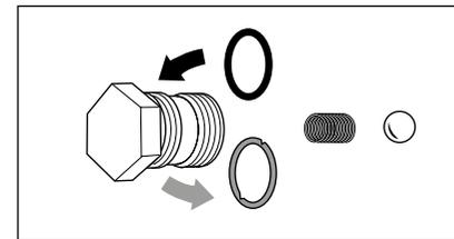
Sind die Dichtungsringe defekt, sofort O-Ringe austauschen.
