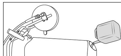
3. Füllen Sie vor Inbetriebnahme Heizöl in den Brennstofftank. (Heizöl EL DIN 51 603 oder Diesel (DIN EN 590) Füllmenge 25 Liter.
