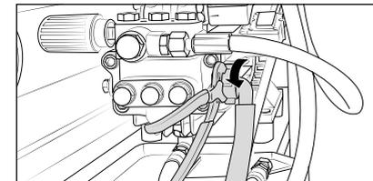
1. Verbindungsschlauch zwischen Hochdruckpumpe und Wasserkasten abschrauben.
