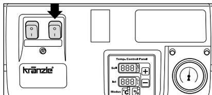
4. Heizungsschalter einschalten. Das Wasser wird erhitzt und konstant auf der eingestellten Temperatur gehalten.
