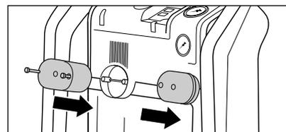
1. Montieren Sie die Netzkabelhalterungen mit den Schrauben.
