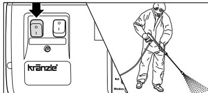
2. Hochdruckreiniger bei geöffneter Sicherheits-Abschaltpistole einschalten. Den Hochdruckreiniger entlüften: Sicherheits-Abschaltpistole mehrmals öffnen und schließen.
