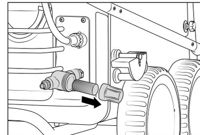
10. **Vor jeder Inbetriebnahme Wassereingangssieb auf Sauberkeit überprüfen.** Filterbecher per Hand abschrauben, das Wassereingangssieb herausnehmen und mit den restlichen Teilen unter klarem Wasser gründlich ausspülen und reinigen. Ist das Sieb verschmutzt kann kein Wasser durchlaufen und sich dadurch kein Druck aufbauen.
