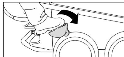
4. Um den Hochdruckreiniger zum Einsatzort bewegen zu können, lösen Sie die Feststellbremse. Der Hochdruckreiniger darf nicht mit angeschlossenem Wasserleitungsschlauch gezogen werden!
