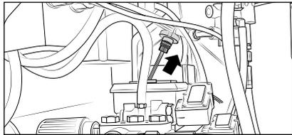
13. **Vor jeder Inbetriebnahme Ölstand am Ölmesstab überprüfen.**
