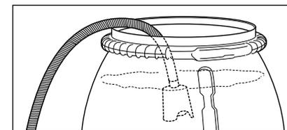
3. Mit Wasser gefüllten Ansaugschlauch in den wassergefüllten Behälter hängen und mit dem Reinigungsvorgang beginnen.
