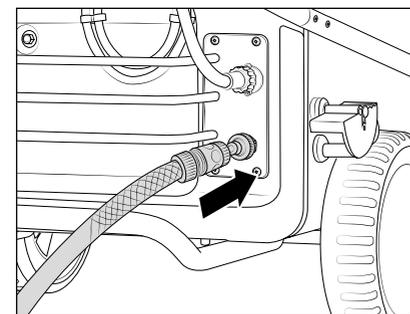
11. Wasserschlauch am Wassereingang anschließen (Mindestanforderungen: 5 m Schlauchlänge, Querschnitt 3/4", 10 bar). Der Hochdruckreiniger kann wahlweise an eine Druckwasserleitung (1 - 10 bar Vordruck) mit kaltem oder bis zu 60 °C warmem Wasser angeschlossen werden. Bei der therm-Serie besteht die Möglichkeit Wasser aus einem Behälter anzusaugen (siehe Direktansaugung).
