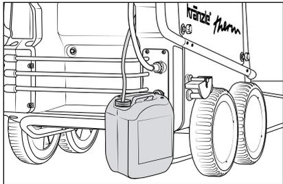
1. Reinigungsmittelinjektorschlauch in Behälter mit Zusatzmittel stecken.
