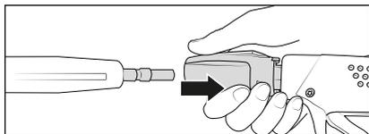
9. Nach Einstecken der Lanze die Sicherungshülse loslassen und auf einen sicheren Sitz der Lanze achten. **Stecknippel regelmäßig mit säurefreiem Fett einschmieren.**
