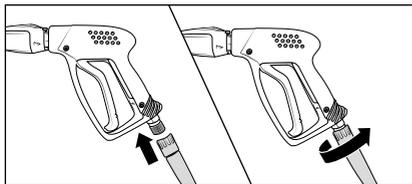
8. Die Sicherungshülse der Sicherheits-Abschalt pistole erst zurückziehen, dann die Lanze in die Steckkupplung der Sicherheits-Abschalt pistole stecken.
