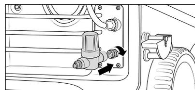
2. Montieren Sie den WassereingangsfILTER (optional erhältlich) am Wassereingang.
