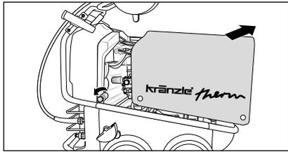
12. Um Zugriff zur Innenausstattung des Hochdruckreinigers zu bekommen, lösen Sie die Schrauben an der Abdeckung. Entnehmen Sie vorsichtig die Haube.
