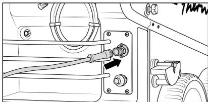
7. Hochdruckschlauch (drehbare Verschraubung - grau) an die Sicherheits-Abschalt pistole aufstecken, fest und druckdicht verschrauben.
