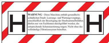
Sauger der Staubklasse H sind geeignet für das Auf-/Absaugen von trockenen, nicht brennbaren Stäuben, krebserzeugenden und krankheitsregenden Partikeln sowie nicht brennbaren Flüssigkeiten, Holzstäuben und gesundheitsgefährlichen Stäuben mit AGWs < 0,1 mg/m<sup>3</sup>.
