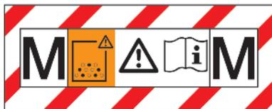
Sauger der Staubklasse M sind geeignet für das Auf-/Absaugen von trockenen, nicht brennbaren Stäuben, nicht brennbaren Flüssigkeiten, Holzstäuben und gefährlichen Stäuben mit AGWs  $\geq 0,1 \text{ mg/m}^3$ .
