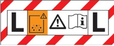
Sauger der Staubklasse L sind geeignet zum Auf-/Absaugen von trockenen, nicht brennbaren, gesundheitsgefährlichen Stäuben mit Arbeitsplatzgrenzwerten (AGWs) > 1 mg/m<sup>3</sup>.
