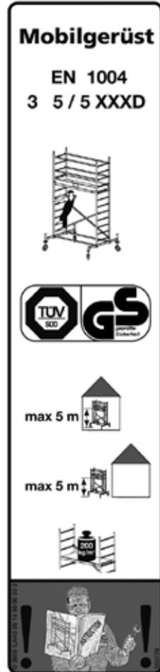
Dieses Typenschild ist an den Vertikalrahmen des Mobilgerüsts angebracht.
