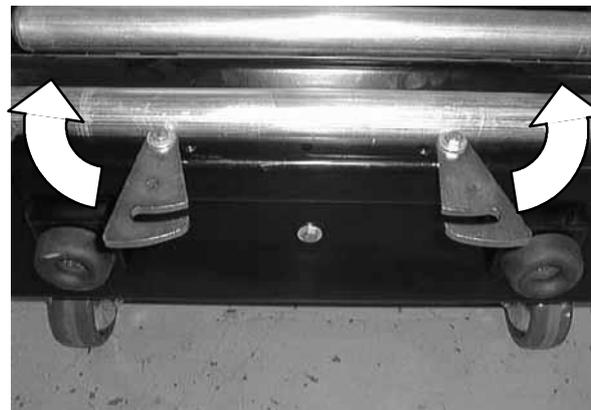
15. Lösen Sie die Bodenverriegelung der Transporteinheit. Um den Bodenverschluss zu lösen, treten Sie auf den rechten Bodenverschluss.
