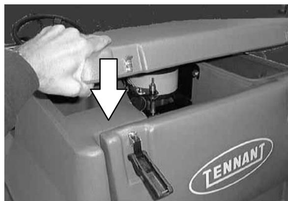
15. Walzen-Schrubbkopf: Senken Sie den Schrubbkopf etwa 25 mm ab. Entfernen Sie den Splint, mit dem die Seiten-Wischgummis an der rechten Seite der Maschine befestigt sind. Schwenken Sie das Wischgummi vom Schrubbkopf weg.
