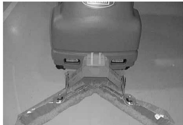
7. Um die *QuickMop*-Schutzabdeckung zu entfernen, lösen Sie die Schnappschalter. Die Schutzabdeckung sollte in regelmäßigen Intervallen entfernt werden, um Wartungsarbeiten vorzunehmen.
