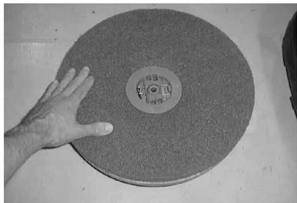
11. Legen Sie die neue Schrubbbürste/den Kissenantrieb auf den Boden neben den Schrubbkopf. Schieben Sie die Bürste unter den Schrubbkopf.
