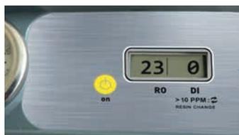
Das **TDS-Meter** zeigt, die Wasserqualität hinter den RO-Membranen und hinter dem DI-Harzfilter an. Die Membranen (RO) sollten mit einem Leistungsgrad von 95-98% im Verhältnis zum Leitungswasser arbeiten. Der Harzfilter (DI) sollte optimalerweise einen Wert von 0 anzeigen. Spätestens wenn er 10 anzeigt, sollte er gewechselt werden.
