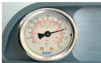
Das **Manometer** zeigt, bei laufender Pumpe, den Wasserdruck auf den Membranen an. Stellen Sie sicher, dass der Wasserdruck mindestens 1 bar beträgt. Optimal sind 4 bar, maximal zulässig sind 6 bar.
