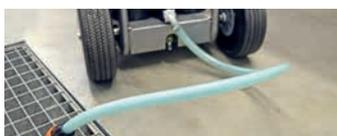
An der Rückseite unten befindet sich der Wasserausgang für das Konzentrat. Leiten Sie das Konzentrat mit dem beiliegenden Konzentratschlauch in einen Abfluss ein.
