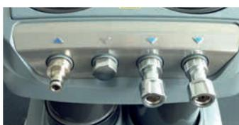
An der Vorderseite befinden sich 2 Anschlüsse für Reinigungsstangen und 1 Anschluss für die Wasserzufuhr. Es handelt sich um Standard-Schlauchanschlüsse.
