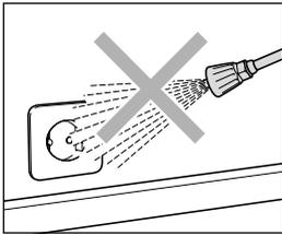
Den Hochdruckstrahl nicht auf Steckdosen oder andere elektrische Einrichtungen richten! Alle im Arbeitsbereich befindlichen stromführenden Teile müssen spritzwassergeschützt sein.
