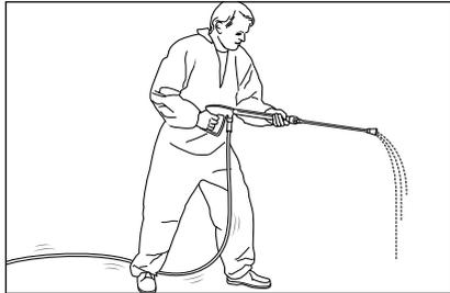
Aus der Lanze kommt ein unregelmäßiger Strahl. Der Hochdruckschlauch vibriert.
