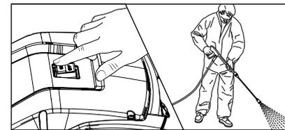
**12.** Hochdruckreiniger bei geöffneter Sicherheits-Abschalt-pistole einschalten. Den Hochdruckreiniger entlüften: Sicherheits-Abschalt-pistole mehrmals öffnen und schließen. Mit dem Reinigungsvorgang beginnen.
