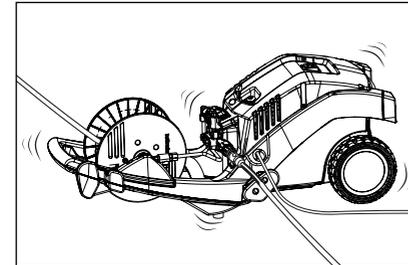
Nach dem Schließen der Sicherheits-Abschalt pistole muss sich der Hochdruckreiniger abschalten. Wenn die Abschaltung nicht erfolgt, kann Leckage an der Hochdruckpumpe, am Druckschalter, am Hochdruckschlauch, oder an der Sicherheits-Abschalt pistole die Ursache sein.
