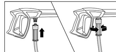
6. Hochdruckschlauch an die Sicherheits-Abschaltpistole aufstecken, fest und druckdicht verschrauben.
