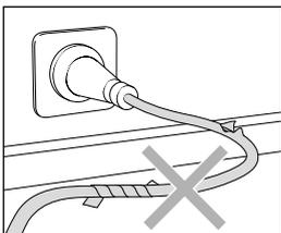
Netzanschlusskabel nur in einwandfreiem Zustand verwenden! Netzanschlusskabel nicht beschädigen (zerren, quetschen, überfahren, ...) oder unsachgemäß reparieren!
