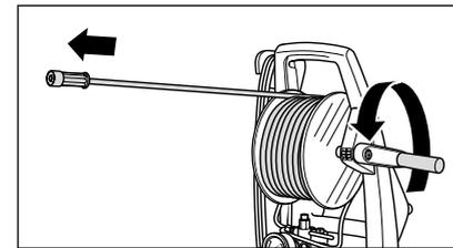
5. Bei Hochdruckreinigern mit Schlauchtrommel, muss diese ganz abgewickelt werden. Bei Hochdruckreinigern ohne Schlauchtrommel muss der im Lieferumfang enthaltene Hochdruckschlauch an den Pumpenausgang fest und druckdicht aufgeschraubt werden. Hochdruckschlauch gerade und schlingenfrei ausrollen.
