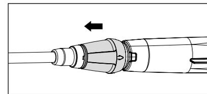
8. Nach Einstecken der Lanze die Sicherungshülse loslassen und auf einen sicheren Sitz der Lanze achten. **Stecknippel regelmäßig mit säurefreiem Fett einschmieren.**
