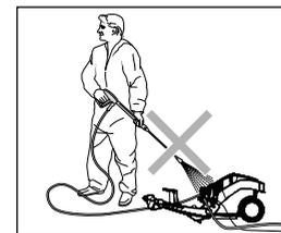
Den Hochdruckreiniger nicht absprühen! Den Hochdruckreiniger nicht dem Sprühnebel des Hochdruckstrahls aussetzen!
