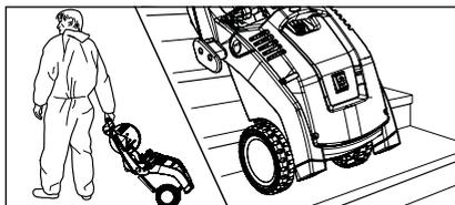
3. Den Hochdruckreiniger zum Einsatzort bewegen. Der K 1050 TS/TST ist ein fahrbarer Hochdruckreiniger mit robustem geländegängigen und treppentauglichen Fahrwerk.
