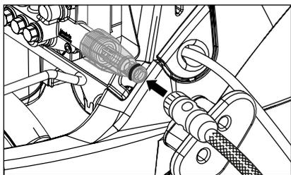
**10.** Wasserschlauch an das Wassereingangssieb anschließen (Mindestanforderungen: 5 m Schlauchlänge, Querschnitt 3/4", 10 bar). Der Hochdruckreiniger kann wahlweise an eine Druckwasserleitung (1 - 10 bar Vordruck) mit kaltem oder bis zu 60 °C warmem Wasser angeschlossen werden.
