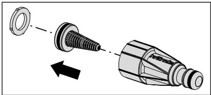
**9.1** Bei Verschmutzung, den Filter herausnehmen und mit den restlichen Teilen unter klarem Wasser gründlich ausspülen und reinigen.
