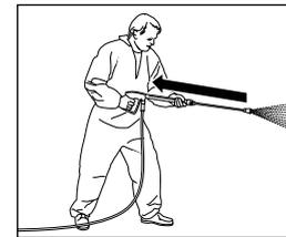
Achten Sie darauf, dass beim Reinigen mit unter Hochdruck stehendem Wasser an der Lanze ein deutlich spürbarer Rückstoß entsteht. Deshalb auf festen Stand achten (siehe technische Daten).
