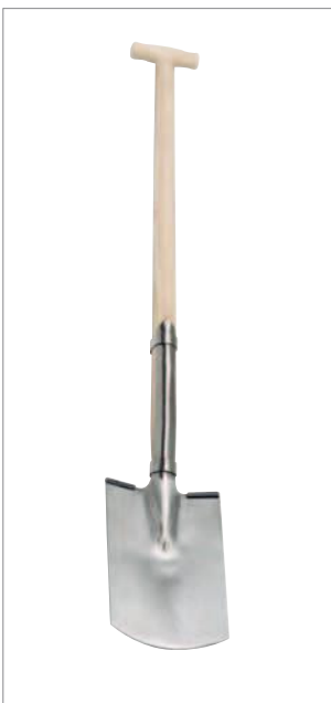
Rodespaten mit T-Griff Äußerst robuster, schwerer Spaten zum Aushebeln von Wurzelwerk. Gehärtetes, blank geschliffenes Blatt, lange Doppelfeder mit zwei Zwingen, Stahltrittshülsen, T-Griff mit Rundung, gebogener Eschenstiel, Blatt L 285 x B 185 mm, VE 1 02405
