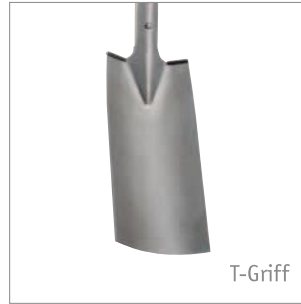
Drainagespaten mit T-Griff Langer Spaten mit gewölbtem Blatt zum Ausheben von Gräben und Drainagen. Gehärtetes Blatt mit blanker Oberfläche, Doppelfeder, zweifach vernietet, Stahltrittshülsen, T-Griff mit Rundung, gebogener Eschenstiel, Blatt L 400 x B 150 mm, VE 1 02406
