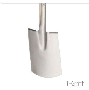
Gärtnerspaten mit T-Griff Sehr robuster Universalspaten. Gehärtetes Blatt, glatte Oberfläche, lange Doppelfeder, zweifach vernietet, Stahltrittshülsen, T-Griff mit Rundung, gebogener Eschenstiel, Blatt L 280 x B 180 mm, VE 1 02403
