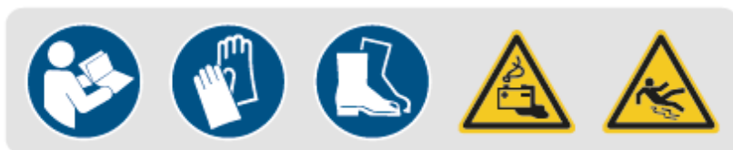
Abb. 1-1: Sicherheitskennzeichnungen - Gebotszeichen: Anleitung beachten, Handschutz benutzen, Fußschutz benutzen | Warnzeichen - Warnung vor Gefahren durch das Aufladen von Batterien, Warnung vor Rutschgefahr
