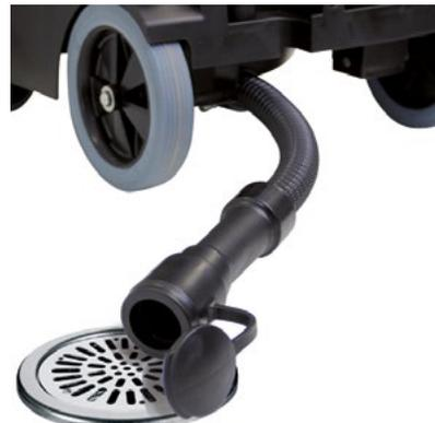
Schmutzwasser-Ablassschlauch zur restlosen Entleerung des Behälters.
