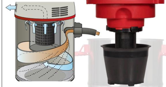
Durch den Drall am Einlaßstutzen wird der Sprühnebel an der Behälterwand abgeschieden. Zusätzliche Filterstoffe sind nicht mehr notwendig. Die zuverlässige Schwimmerabschaltung reagiert selbst bei extremer Schaumbildung. Seitliche Kühl-Luftschnitte sorgen für konsequente Trennung von Kühl- und Prozessluft.
