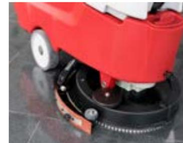
Saugbalken schwenkt automatisch in die Arbeitsrichtung.
