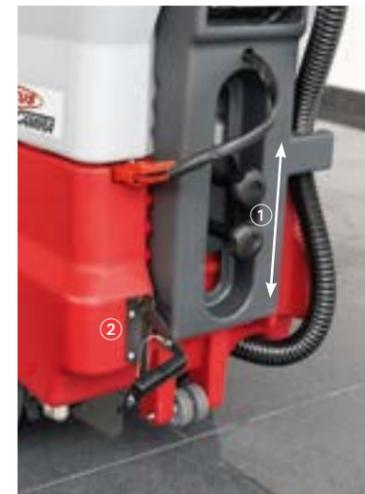
① Die Arbeitshöhe der Bedieneinheit kann individuell eingestellt werden.
