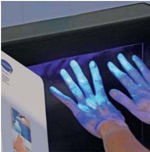
Neben den praktischen Abmessungen überzeugt die UV-Box aber auch durch Stabilität und technische Details: Die Elektronik wurde aus Sicherheitsgründen unterhalb der Lampen mit einer UV-durchlässigen Plexiglasplatte verkleidet. Gleichzeitig sind die Bedienfelder gut erreichbar und unempfindlich hinsichtlich ihrer Belastbarkeit. Wie beim Notebook üblich, gehört ein dreipoliger Stecker mit 1,8 m Netzzuleitung zum Lieferumfang.
