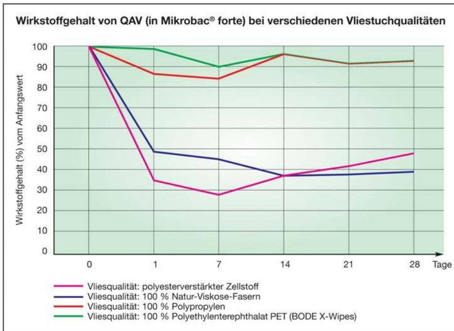
Ein hoher Wirkstoffgehalt ist der Indikator für ein geringes Adsorptionsverhalten der QAV an die Fasern. Als beste Vliestuchqualität schneidet PET mit der kontinuierlich höchsten Konzentration von etwa 100 Prozent ab, d. h. der Wirkstoff wird nahezu vollständig an die zu desinfizierende Fläche abgegeben.
