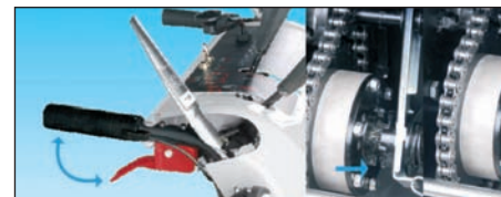
Die benutzerfreundliche Bedienung des Getriebes ermöglicht einen einfachen Richtungswechsel
