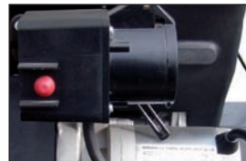
Elektrostart mit Zündschlüssel. Über eine Verbindung zu einer 230V Steckdose lässt sich der Motor einfach durch Drücken eines Knopfes starten
