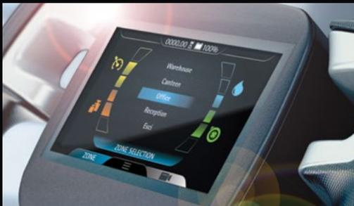
Um stets die gewünschten Reinigungsstandards zu erreichen und Manipulationen zu vermeiden, kann der Werkstatteleiter verschiedene Umgebungsarten einspeichern und ihnen unterschiedliche Reinigungsparameter zuordnen. Der Bediener muss nur den Bereich auswählen, den er reinigen will, um eine bereits richtig voreingestellte Arbeitskonfiguration zu erhalten
