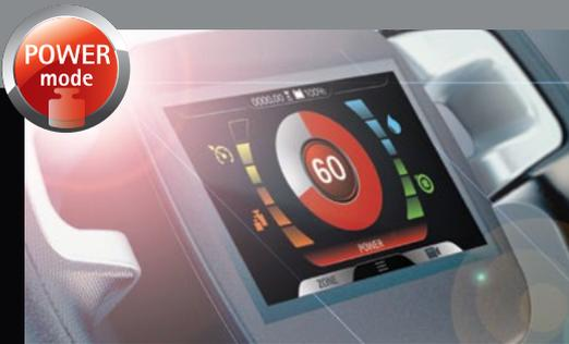
Wenn mehr Schubbkraft erforderlich ist, kann Power Mode aktiviert werden, das den Durchsatz der Reinigungslösung, den Druck und die Saugkraft so lange erhöht, wie erforderlich ist, um hartnäckigen Schmutz zu beseitigen
