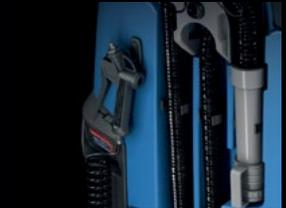
Desinfektionspistole zur Desinfektion der Maschine am Ende der Schicht (nur mit dem Disinfector erhältlich)
