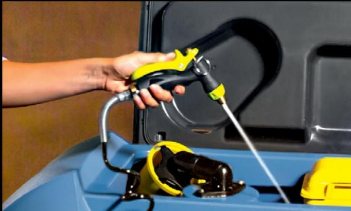
Die Sprühpietole erfüllt zwei Funktionen. Bei der Wartung der Maschine erleichtert sie das Ausspülen der Tanks am Ende der Arbeitsschicht. Während des Einsatzes kann sie hingegen zum Befeuchten von anhaftenden Schmutzflecken für deren leichtere Entfernung verwendet werden.
