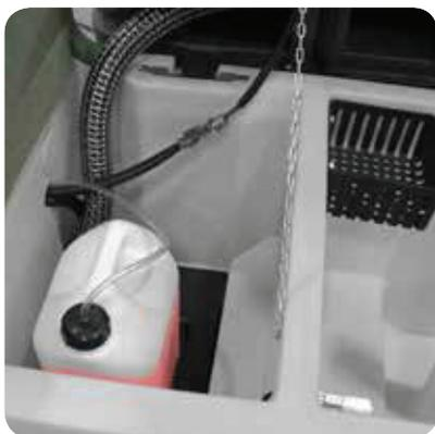
Durchflusssystem. Automatische Bürstenanhebung (nur Modell 66BTA). Automatisches Reinigungsmittel-Dosiersystem. Kompletter Zugriff auf Auffang-Wassertank mit Sichtprüfung. Einfacher Zugang zum Auffangbehälter. Leichter Zugang und einfache
