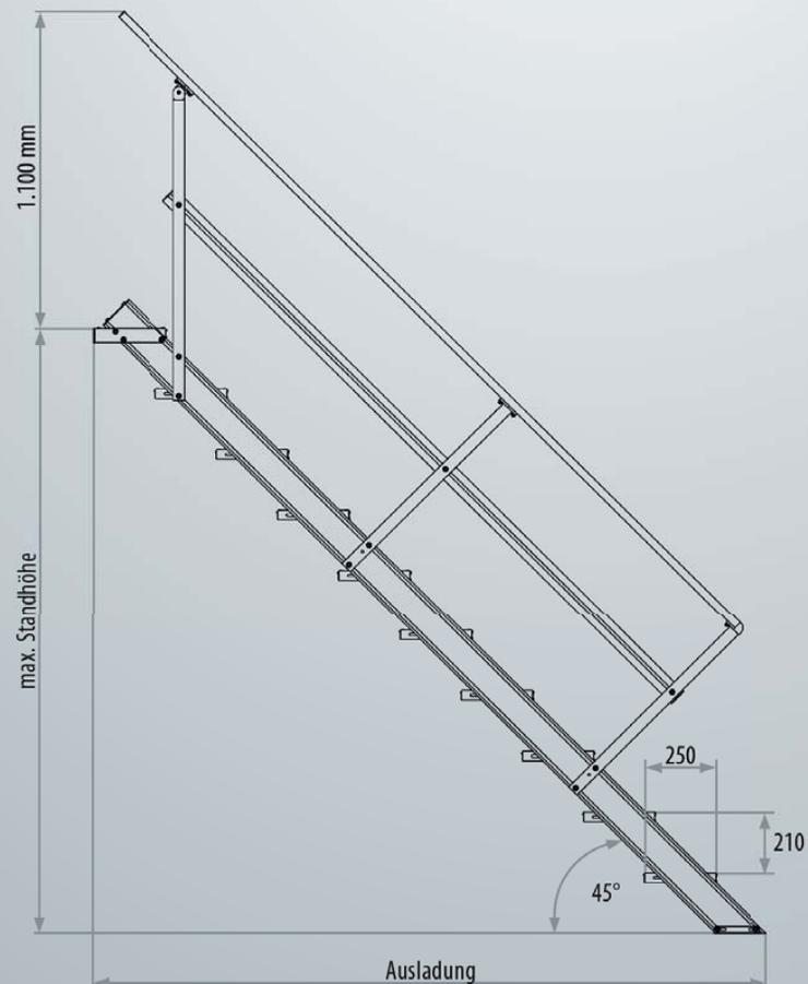
**Stufenbreite 600 mm**
