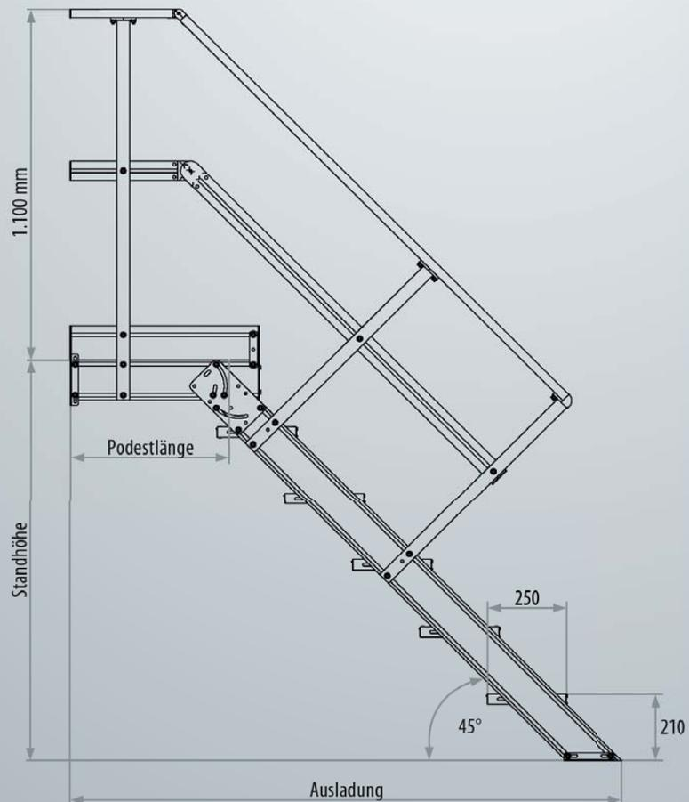
**Stufenbreite 600 mm**
