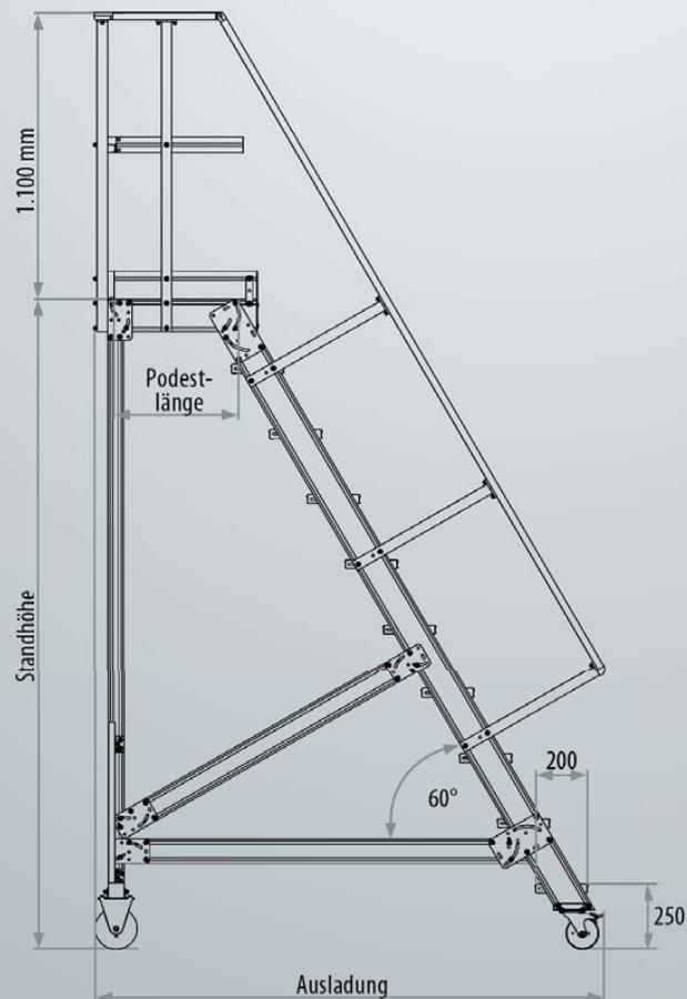
**Stufenbreite 600 mm**
