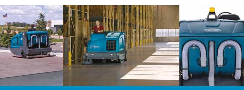
Die vollständig kombinierte Kehrsaug-/Scheuersaugmaschine M30 wurde für eine verlässliche Reinigung für den industriellen Einsatz entwickelt, wo Scheuersaugen, Kehren oder beides gleichzeitig erforderlich ist.
