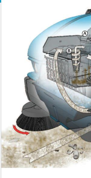
Bedienersicherheit inclusive! Durch die Brandschutzsicherung wird bei steigender Temperatur im Kehrgutbehälter die Luftzufuhr unterbrochen.
