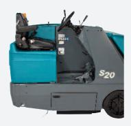
Der komfortable Bedienerplatz beinhaltet einen verstellbaren Sitz und ein verstellbares Fahrpedal, sowie ein verstellbares Lenkrad. Wichtige Sicherheitsfunktionen beinhalten ausgezeichnete Rundumsicht des Bedieners, freie Sicht auf den Seitenbesen, einfache Bedienung, Kontrolleuchte für Parkbremse und vieles mehr.
